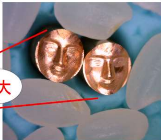
【写真2】マイクロ・ナノ融合加工法による微細能面加工
