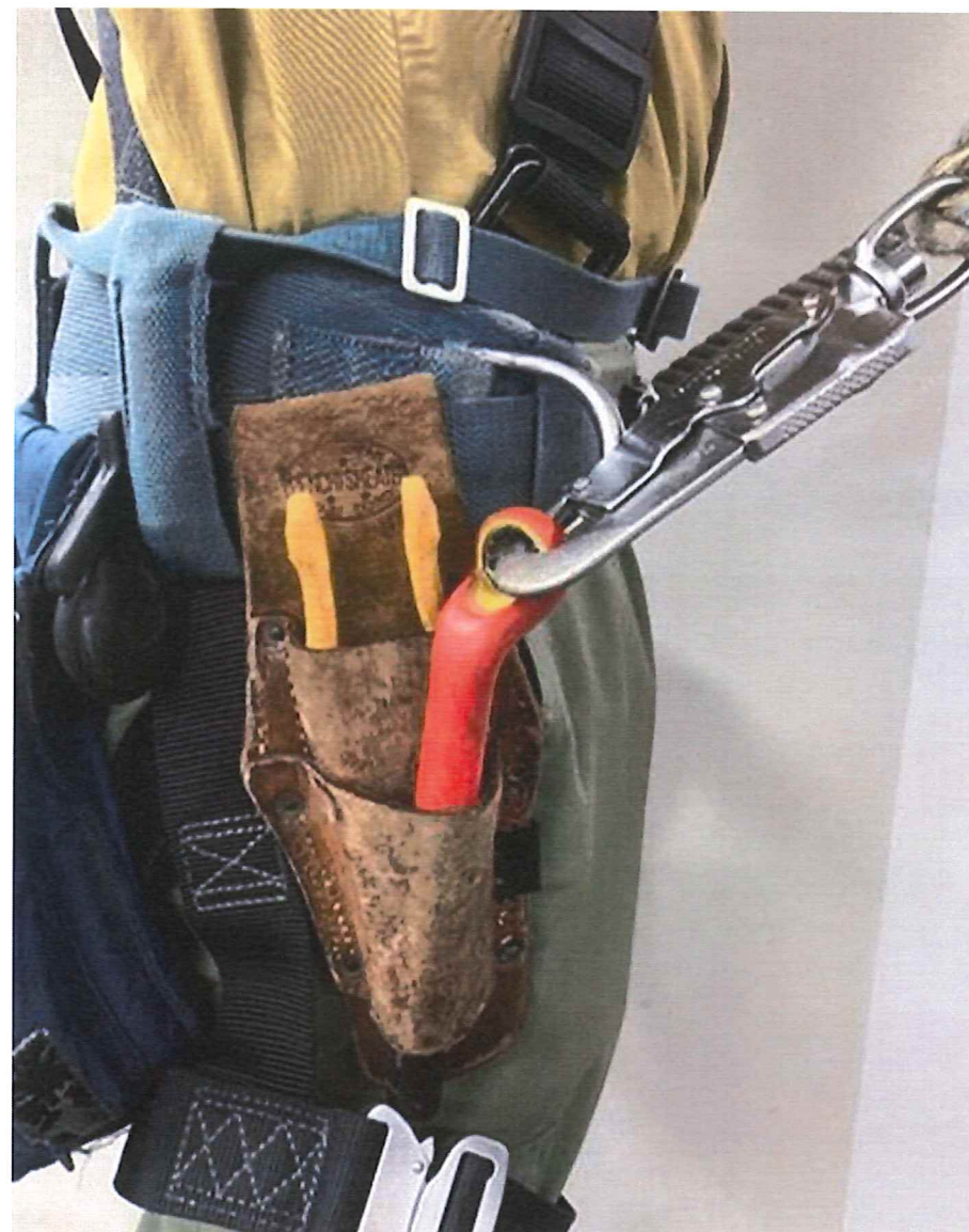
写真3 本フックが保持レンチに掛かっていた状態 (再現)
