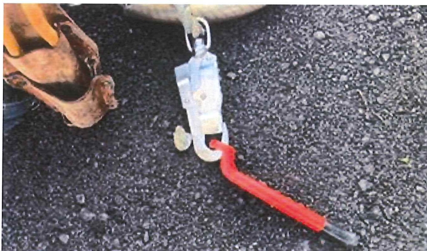
写真1 本フックは保持レンチに掛かっていた
